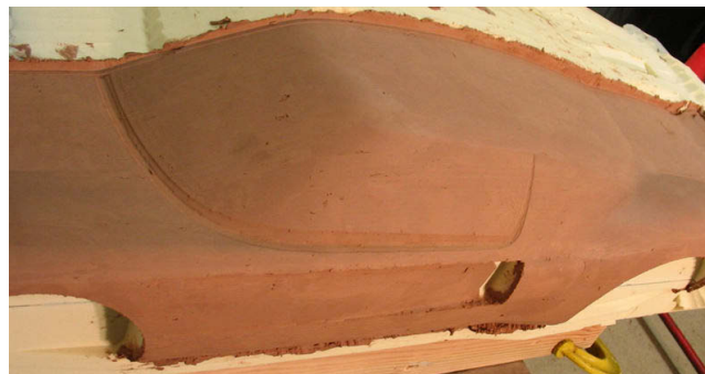
Fig. 17. Actual machining of the top portion of GT40.
